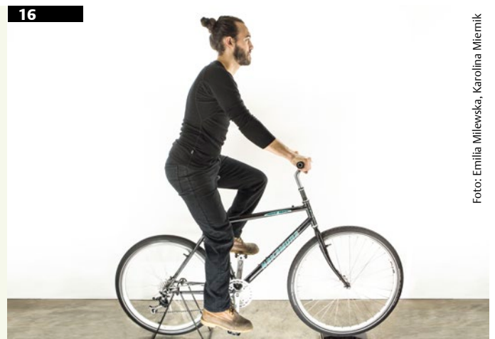
Abb. 15-16 Links: ein normales Mountainbike, das prinzipiell für Offroad-Gelände konzipiert wurde, aber auch oft auf der Straße verwendet wird. Rechts: das gleiche Bike mit stärker positivem Vorbau, größerem Vorderrad mit dazugehöriger Gabel. Man beachte die Haltungsänderungen in der LWS und der HWS!
