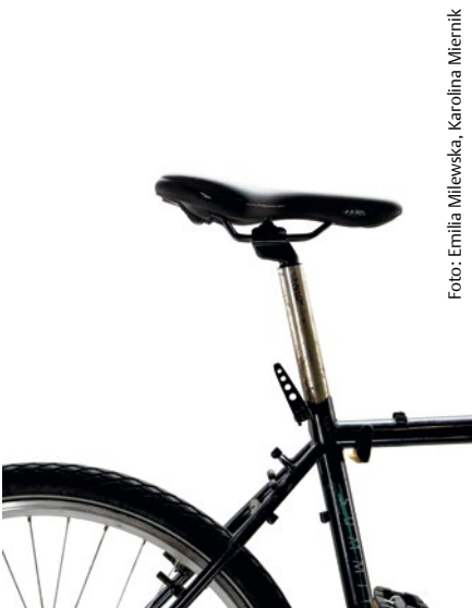
Abb. 12 Die Sattelhöhe stellt man über die Sattelstütze ein.
