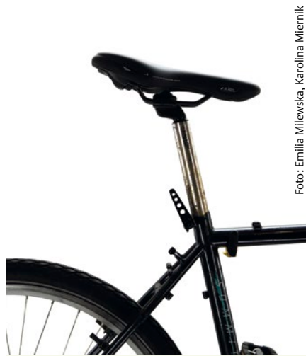
Abb. 13 Ein um 10 bis 15 Grad nach vorne geneigter Sattel trägt zu einer physiologischeren Wirbelsäulenposition beim Radfahren bei.
