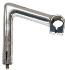
Abb. 3 Der sogenannte Vorbau verbindet den Lenker mit der Gabel: hier ein negativer Vorbau.
